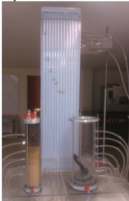
Figura 21. Cabeza hidráulica y diferencia de nivel.
