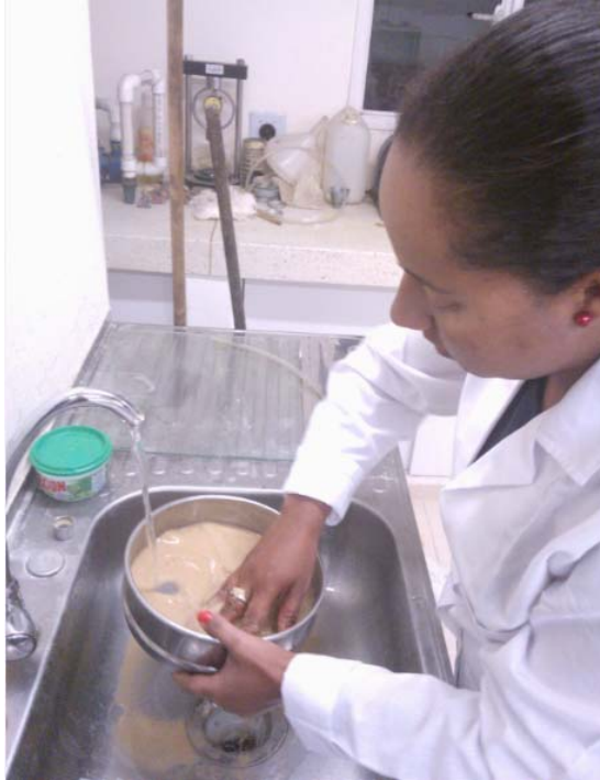
Figura 15. Lavado del material para eliminar los finos.
