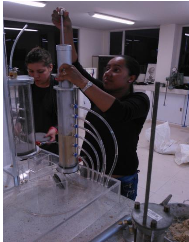
Compactación del material Fuente: Propia Autoría.
