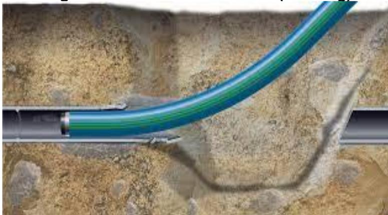
Fuente: Yepes. ¿Cómo renovar tuberías con el método relining? [33]
