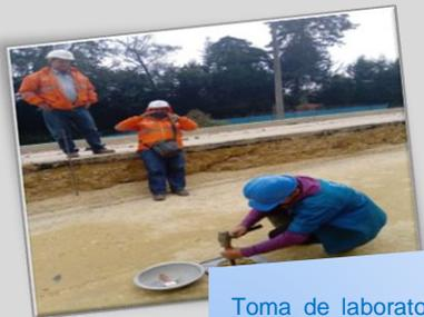
Toma de laboratorios densidades de la base granular según norma IDU (mayor al 98%).
