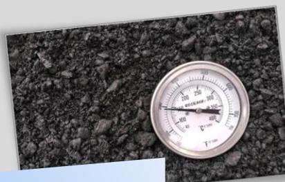
Control de temperatura de material asfáltico previo a sello y compactación para verificación y control.
