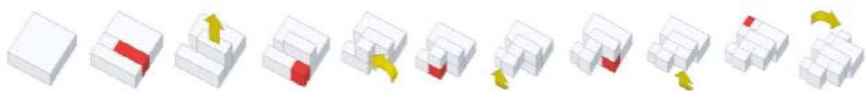
Se parte de una forma completa, un cubo que toma trasformaciones por sustracciones de piezas que poco a poco, con una logita de diseño da lugar a un modelo de vivienda ordeno y totalmente funcional, dando como resultado una planta geoméricamente formada por cuadrados.
