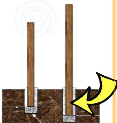
Debemos utilizar dos palos robustos para que el atrapanieblas resulte exitoso. Asimismo, debemos enterrarlos de manera profunda, relleno el hueco en la tierra con piedras a presión.
