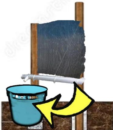
Finalmente, el tanque recolector del agua puede ser reciclado de aquellos que ya no lo usan.
