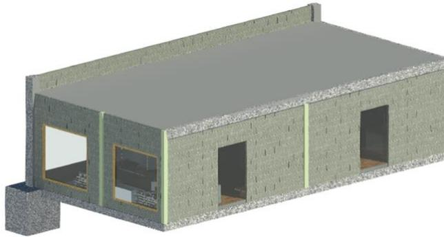
*Ilustración 66.Revit bodega en ladrillo plástico reciclado Fuente: Elaboración propia*
