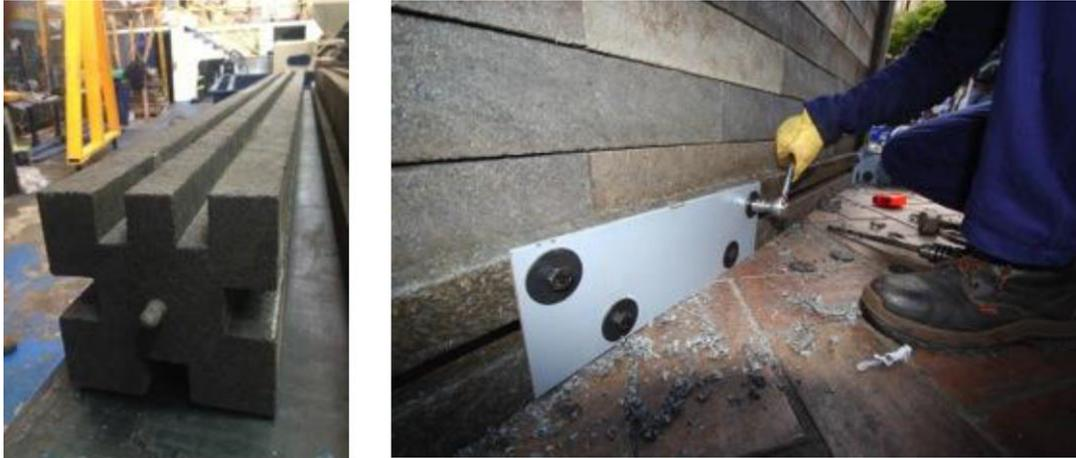
*Ilustración 56. Ensamble de ladrillos plásticos*
